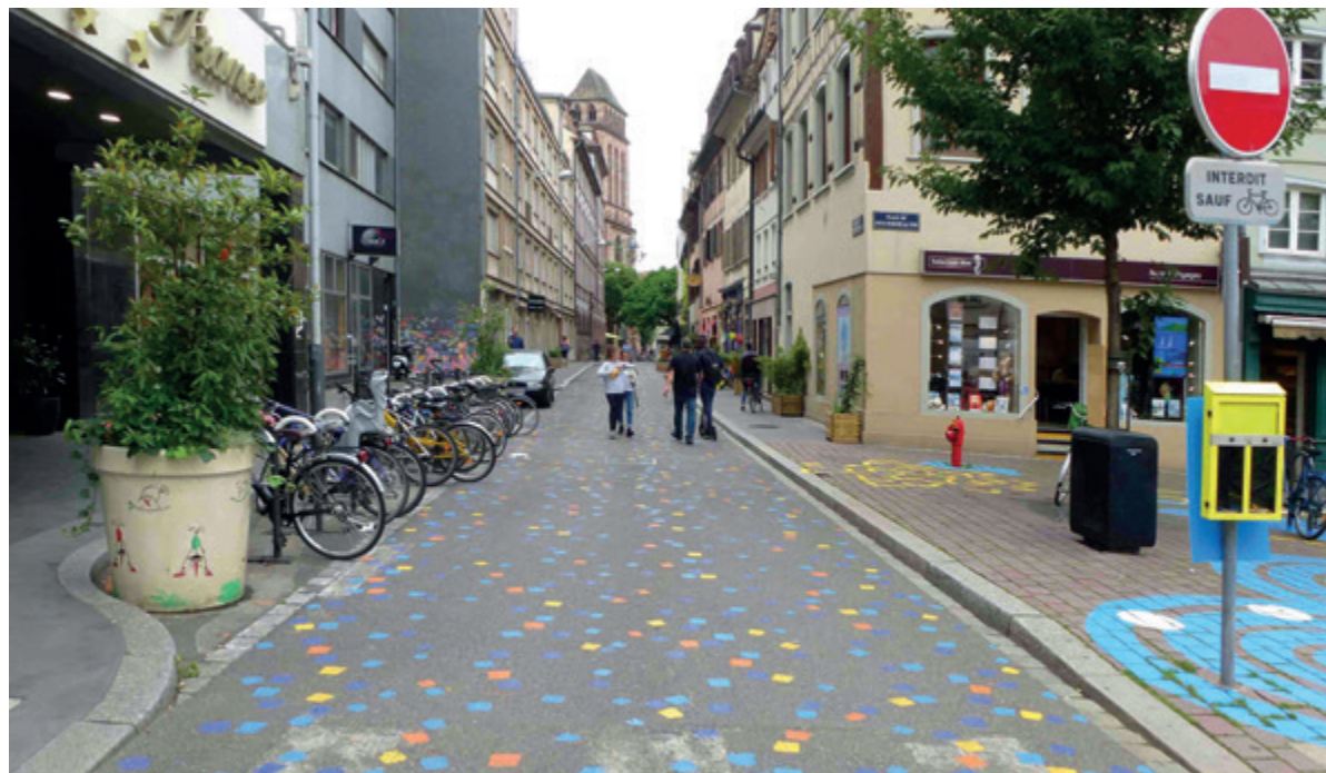
Utilisation du marquage d'animation dans une rue classique pour appuyer le changement de statut (passage en aire piétonne) sans reprise du profil
