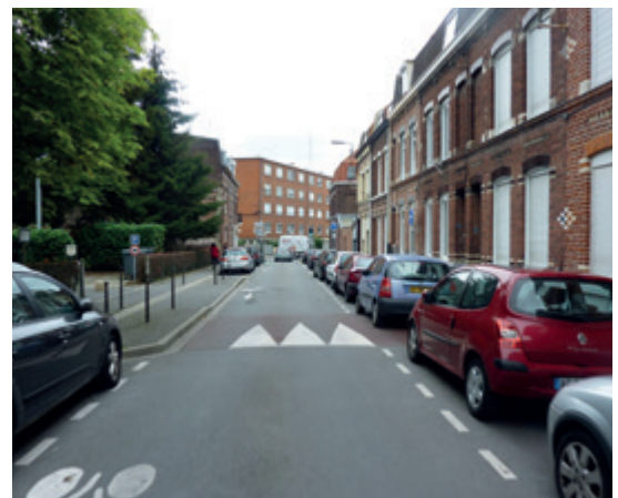
Exemple d'un ralentisseur de type dos-d'âne. Dans cette rue rectiligne, avec beaucoup de stationnements et peu de présence piétonne, les conducteurs avaient tendance à reprendre de la vitesse. Ce n'est désormais plus le cas.
