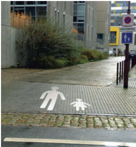
Exemple d'un marquage d'entrée d'une aire piétonne
