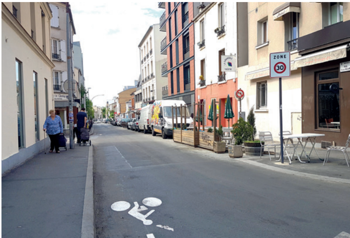
À cette entrée de zone 30, deux places de stationnement sont neutralisées pour installer une terrasse de restaurant. Les façades débordent sur la rue. Cela signale aux usagers qu'ils se trouvent dans une rue, un quartier qui vit avec des habitants et des promeneurs, et non un simple axe de circulation.
