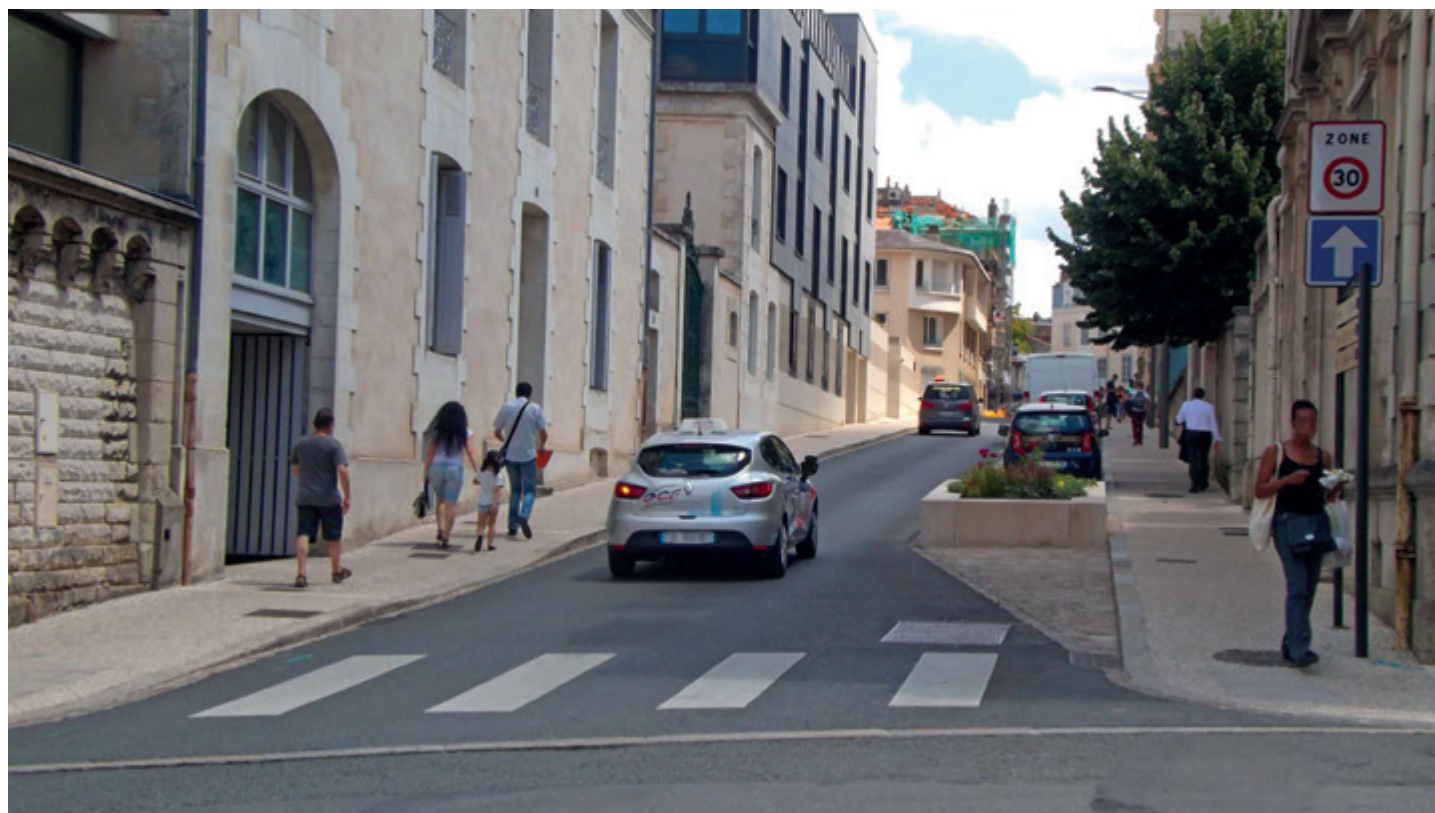
Ici, l'entrée de la zone 30 est marquée par une tête de stationnement bâti en massif végétal. La bordure est basse, il n'y a pas de potelets.
