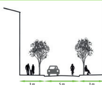
Chaussée à double sens : rue où l'on veut privilégier les déplacements des piétons et l'accès aux façades (commerces). Les larges trottoirs permettent l'installation de plantations et de mobilier.
